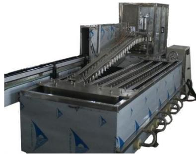
Este baño automático para aerosoles cuenta con un sistema de secado por aire a la salida de la cinta transportadora, antes de traspasarse a la línea.
